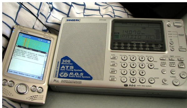
ATS909 v sodelovanju z dlančnikom in programčkom „Pocket Digi“, odlična kombinacija za PSK ali RTTY portable SWL.
