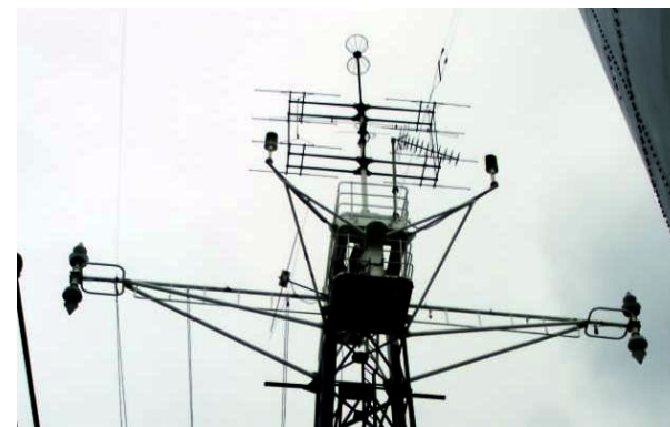
Zadnji antenski stolp – na vrhu prevladujejo antene radarskega sistema „Type 281“, namenjenega predvsem nadzoru zračnega prostora. Deloval je na valovni dolžini 3,3 metra z močjo 350kW, kar je omogočalo doseg do 120NM. Antenski sistem se je zavrtil štirikrat na minuto.
