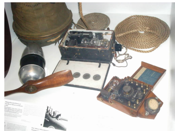
Letalski radijski oddajnik iz leta 1918. Električno energijo je dobival iz generatorja na propeler (levo)
