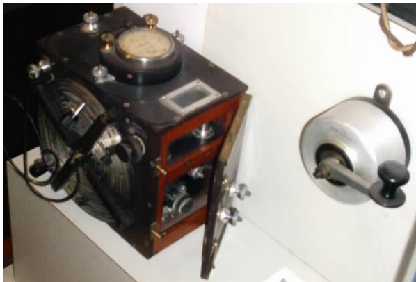
Sterling aircraft transmitter, 1915. Tako oddajnik kot telegrafska ročica sta neprodušno zaprta, kar naj bi preprečevalo vžig morebitnih hlapov goriva v letalu.
