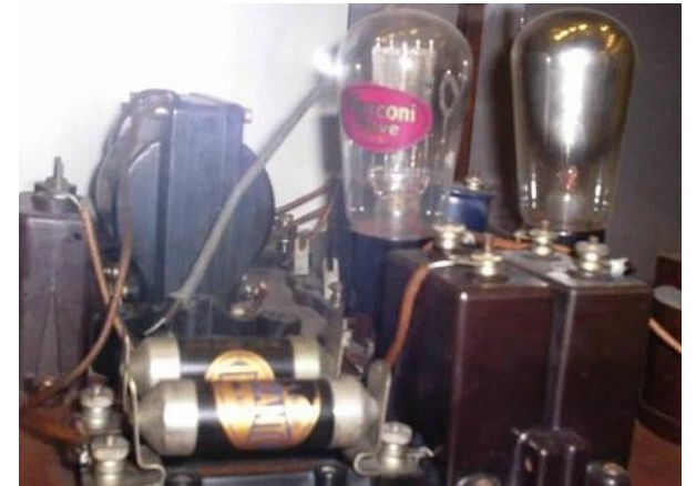
Drobovje 10-vatnega dolgovalovnega (150- 170 metrov) oddajnika za telegrafijo in telefonijo
