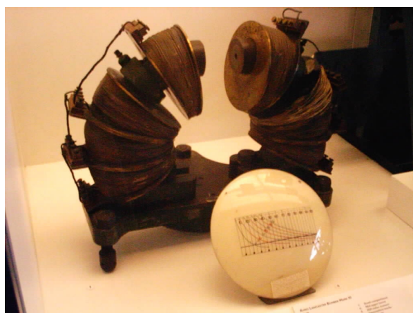
Laboratorijski elektromagnet (Randall in Boot) za eksperimentalni magnetron (prvi poskusi z radarjem). Pod njim je delno prosojni zaslon iz pleksiglasa, na katerem je umerjena skala razdalj - ta zaslon je pri uporabi prekrival katodno cev zaslona radarja „Chain Home Low“ (cca. 1942).
