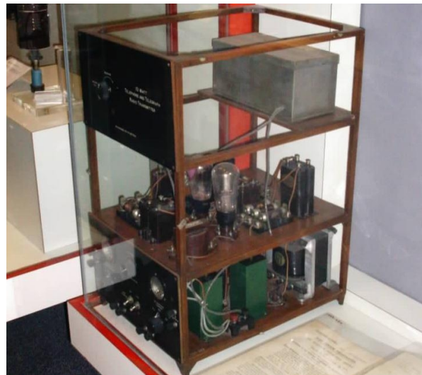
10-vatni oddajnik za telegrafijo in telefonijo, valovne dolžine 150-170 metrov
