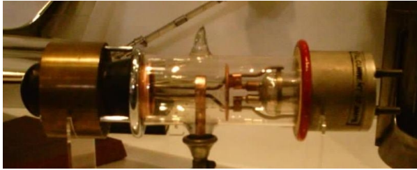
Močnostna trioda Marconi Osram VT98A (cca. 1941). Elektronka je bila uporabljena v britanskem mobilnem radarskem oddajniku tipa MB2, delujočem na valovni dolžini 1.5 metra. Deloval je v sklopu radarskega sistema „Chain Home Low“. Ta radar je dopolnjeval glavni britanski obrambni radarski sistem „Chain Home“, kateri ni mogel zaznavati nizkoletnih letal.
